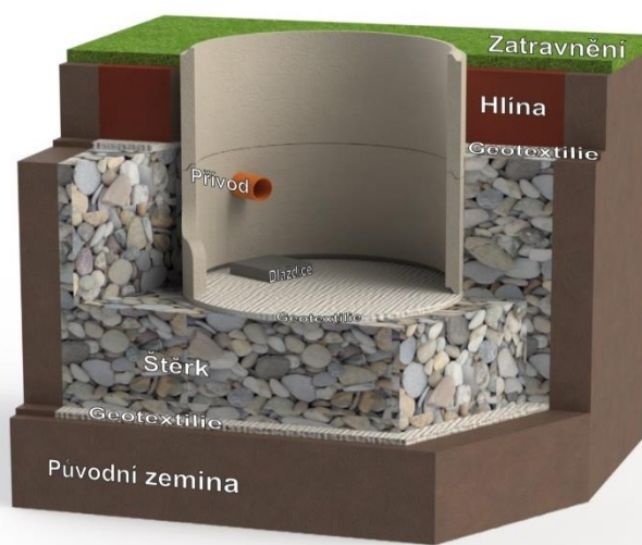
Obr. č. 29. Vsakovací studna vystrojená štěrkem
